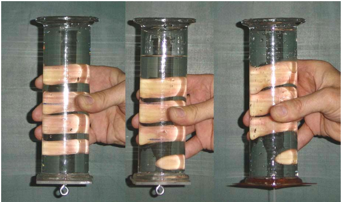
Sl. 3: Inačice pokusa s okrenutom čašom, lijevo: cilindar posve napunjen vodom poklopljen pločicom od pleksiglasa; u sredini: djelomično napunjen cilindar; desno: cilindar poklopljen mrežicom.
